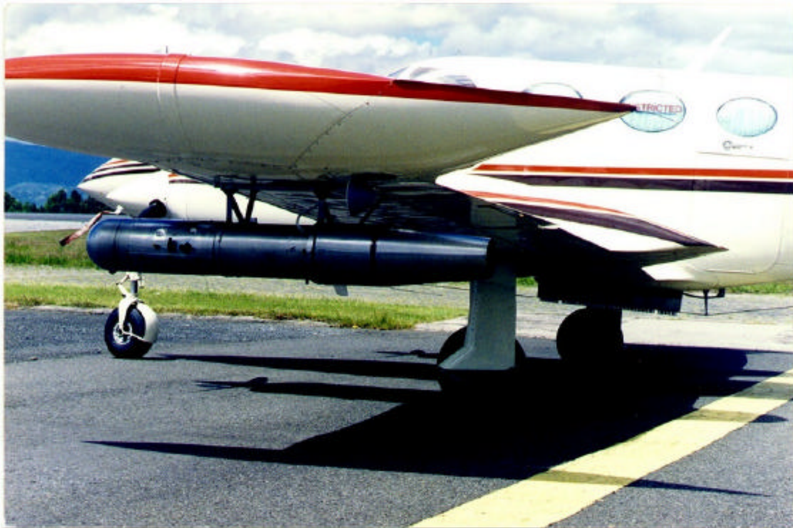
Figura 2 Generador de Acetona-Yoduro de Plata y Portabengalas de Yoduro de Plata por Goteo
